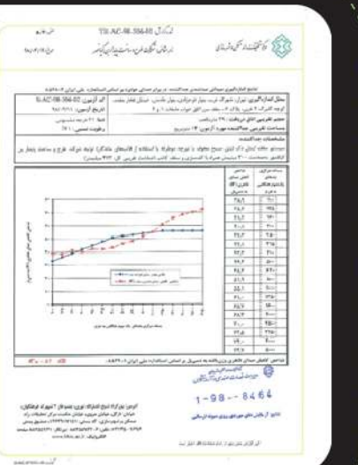
نتایج اندازه گیری میدانی صدابندی سقف در برابر صدای کوبه ای و هوابرد
