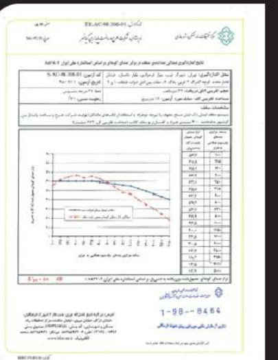
نتایج اندازه گیری میدانی صدابندی سقف در برابر صدای کوبه ای و هوابرد
